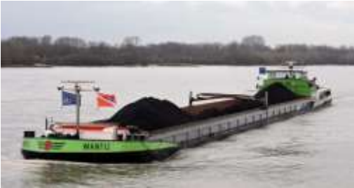
Ms Wantij 86m x 9m 1657 Ton 2X DAF Paccar MX13-355 voortstuwing
