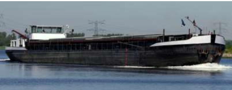
Ms Nosce Orbis 84m x 9m 1500 Ton 2X DAF Paccar MX13-390 voortstuwing
