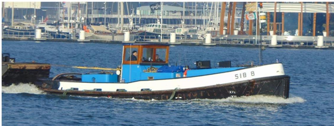
Waternet SB3 en SB8 DAF Paccar MX11-300 hybride voortstuwing
